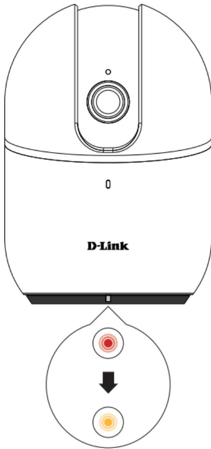
Sobald die Kamera gestartet wurde, dreht sie sich nach links und rechts, oben und unten, um sich selbst zu kalibrieren. Warten Sie, bis die LED auf der Vorderseite von Rot zu orange blinkend wechselt.
