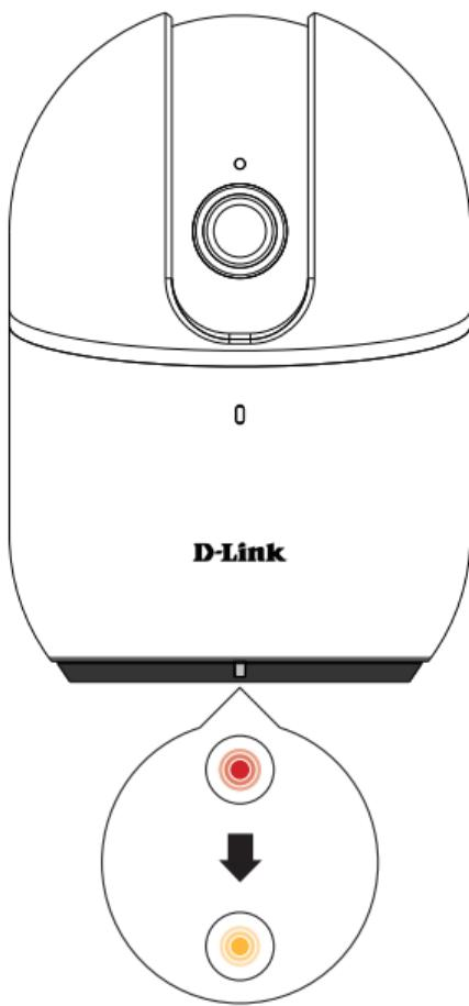
När kameran är fulladdad roterar den åt vänster och höger, upp och ner för att kalibrera sig själv. Vänta tills lysdioden på framsidan ändras från rött till blinkande orange.
