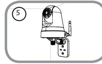
Richten Sie den Winkel des Arms auf der Halterung Ihren Wünschen entsprechend ein. Ziehen Sie die Flügelschraube an, um den Arm in dieser Position zu fixieren.
