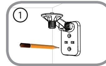
Verwenden Sie die geeigneten Werkzeuge, um zwei Löcher mit dem gleichen Durchmesser wie die der entsprechenden Plastikdübel zu bohren. Setzen Sie anschließend die Dübel in die Bohrlöcher ein, um den Schrauben mehr Halt zu geben.
