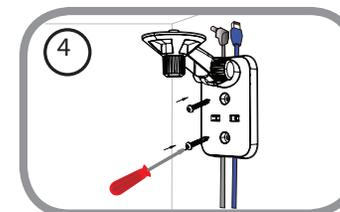
Verwenden Sie die im Lieferumfang des Produkts enthaltene Flügelschraube, um die Kamera an der Halterung zu befestigen. Schließen Sie Strom- und Ethernet-Kabel an der Kamera an.
