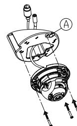
Снимите внутреннюю крышку камеры. Отрегулируйте положение объектива, после чего установите внутреннюю крышку на место.
