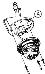
Remova a capa de proteção e ajuste o ângulo e rotação da câmera conforme desejado, então recoloque a proteção de volta ao local de origem.
