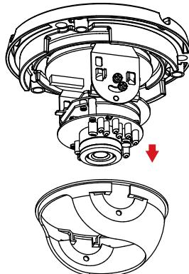
Solte o parafuso de ajuste no lado da câmera, volte a apertá-lo depois de mover a câmera para o ângulo desejado. Você também pode girar a câmera, segurando-a para a esquerda ou direita.
