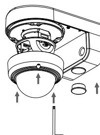
Si va a pasar los cables de la cámara a través de la pared, coloque el tope de goma en el canal del cable inferior para sellarlo.
