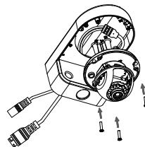
Retirez le couvercle intérieur et ajustez l'angle et la rotation de la caméra comme vous le souhaitez, puis remettez le couvercle intérieur en place.
