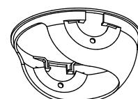
После того как регулировка положения камеры будет завершена, установите внутреннюю крышку на место.
