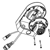
Rimuovere la copertura interna e regolare l'angolo e la rotazione della videocamera secondo necessità, quindi rimontare la copertura interna in posizione.
