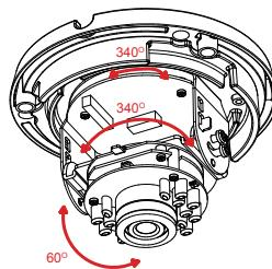
**Remarque:** la caméra possède une amplitude de mouvement limitée ; si elle s'arrête pendant que vous l'ajustez, ne tentez pas de la faire pivoter ou de l'incliner plus loin dans cette direction.
