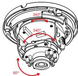
**Nota:** la cámara tiene un rango de movimiento limitado; si se detiene cuando está ajustándola, no intente girar ni inclinar más la cámara en esa dirección.
