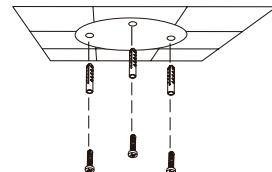
**Se i cavi della telecamera sono nascosti nel muro**, praticare con il trapano un foro al centro e far passare i cavi attraverso il foro.
