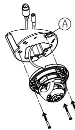
Retire la cubierta interna, ajuste el ángulo y la rotación de la cámara como desee y, a continuación, vuelva a colocar la cubierta interna en su lugar.
