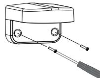
Retire la cubierta de la cámara.
