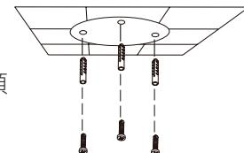
請依照牆面的材質以適當的工具，用6mm的鑽頭鑽約25mm深的孔，然後放入壁虎以支撐螺絲。
