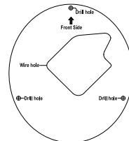
Gunakan sekrup yang disediakan untuk memasang DCS-37-3 pada dinding menggunakan lubang pemasangan dalam.
