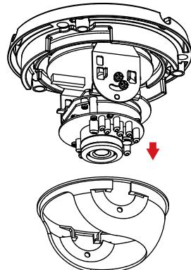
Allentare la vite di regolazione sul lato della telecamera, quindi serrarla di nuovo dopo aver impostato la corretta angolazione per la telecamera. Per ruotare la telecamera, è anche possibile afferrarla e girarla verso destra o sinistra.
