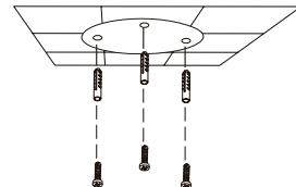
**Если требуется проложить кабели для камеры в стене**, просверлите отверстие в центре и протяните кабели через это отверстие.
