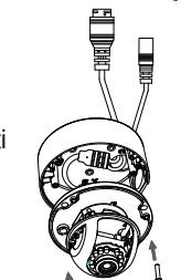
Rimuovere la copertura interna e regolare l'angolo e la rotazione della videocamera secondo necessità, quindi rimontare la copertura interna in posizione.
