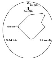
Utilice los tornillos suministrados para montar el DCS-37-3 en la pared usando los orificios de montaje internos.
