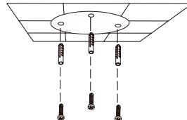
**Si pasa los cables de la cámara a través de la pared,** taladre un agujero en el centro y tire de los cables a través del orificio.
