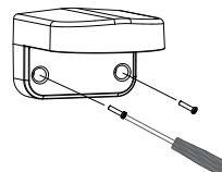
Снимите крышку основания камеры.
