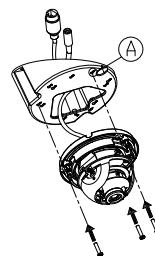
Rimuovere la copertura interna e regolare l'angolo e la rotazione della videocamera secondo necessità, quindi rimontare la copertura interna in posizione.
