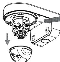
Acople la cubierta de la cámara.
