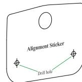
Gunakan sekrup yang disediakan untuk memasang DCS-37-1 ke dinding.
