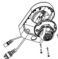
Führen Sie die Kamerasteckverbindungen durch den rück- oder unterseitigen Kabelkanal an der DCS-37-1. Befestigen Sie die Kamera mithilfe der mitgelieferten Schrauben an der DCS-37-1, indem Sie die mit dem Buchstaben A gekennzeichneten Montagelöcher nutzen.
