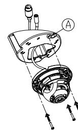
Nehmen Sie die Innenabdeckung der Kamera ab und stellen Sie den Winkel und die Drehung der Kamera Ihren Wünschen entsprechend ein. Bringen Sie anschließend die Innenabdeckung wieder an.
