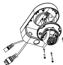
Remova a capa de proteção e ajuste o ângulo e rotação da câmara conforme desejado, então recoloque a proteção de volta ao local de origem.
