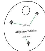
Bringen Sie die DCS-37-2 mithilfe der mitgelieferten Schrauben für die inneren Montagelöcher an der Wand an.
