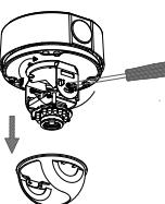
Снимите внутреннюю крышку камеры. Отрегулируйте положение объектива, после чего установите внутреннюю крышку на место.
