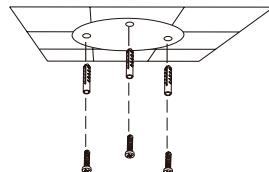
**Se você estiver passando os cabos da câmera através da parede,** faça um buraco no centro e puxe os cabos através do orifício.
