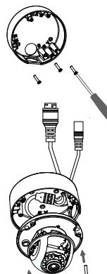
Снимите крышку основания камеры.
