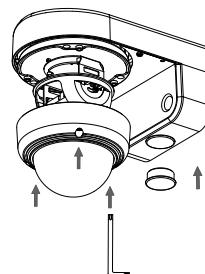
Werden die Kamerakabel durch die Wand geführt, setzen Sie den Gummistopfen in den unteren Kabelkanal, um ihn abzudichten.
