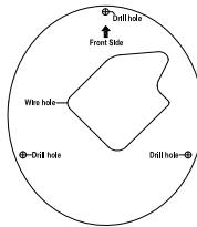
Utilisez les vis fournies pour monter le DCS-37-3 au mur en utilisant les trous de fixation intérieurs.
