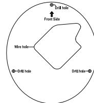
Utilizzare le viti fornite per fissare il supporto DCS-37-3 alla parete utilizzando i fori di montaggio più interni.
