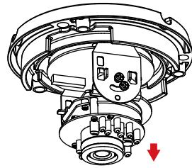
Desserrez la vis de réglage sur le côté de la caméra, puis resserrez-la après avoir déplacé la caméra pour qu'elle soit dans l'angle que vous souhaitez. Vous pouvez également faire pivoter la caméra en la saisissant et en la tournant vers la gauche ou vers la droite.
