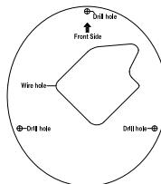
Use os parafusos fornecidos para montar o DCS-37-3 na parede utilizando os furos de montagem interiores.
