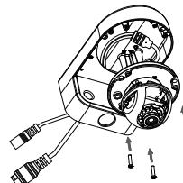
Pase los conectores de la cámara a través del canal del cable posterior o inferior del DCS-37-1. Utilice los tornillos suministrados para montar la cámara en el DCS-37-1 usando el juego de orificios de montaje marcados como A.
