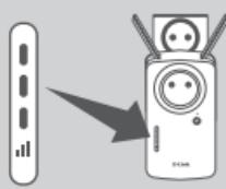
Zeigt die intelligente Signalstärke-Anzeige nach Herstellen der Verbindung nur einen gelben Balken an, hat der DAP-1635 eine Verbindung minderer Qualität hergestellt. Um die Verbindungsqualität zu verbessern, sollte der DAP-1635 an einer Steckdose angeschlossen werden, die näher am drahtlosen Haupt-Router oder -AP ist. Je mehr Balken der Signalstärke-Anzeige leuchten, umso besser ist die Qualität des Funksignals.
