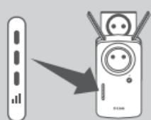
Si le voyant de signalisation intelligent n'a qu'une unique barre couleur ambré après la fin du processus de connexion, cela signifie que le DAP-1635 a établi une connexion de mauvaise qualité. Pour améliorer la qualité de la connexion, le DAP-1635 doit être déplacé sur une prise murale plus proche du PA ou du routeur sans fil source. Plus le nombre de barres allumées est important sur le voyant de signalisation, meilleur est le signal sans fil.
