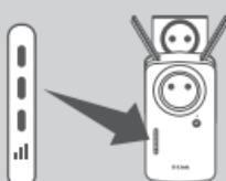
Ha az intelligens jelzőfény egy sárga sávval világít a csatlakozási folyamat befejezte után, akkor a(z) DAP-1635 létrejött kapcsolódásának minősége gyenge. A csatlakozás minőségének javításához a(z) DAP-1635 terméket olyan fali aljzatba kell áthelyezni, amely közelebb van a forrásként működő vezeték nélküli routerhez vagy hozzáférési ponthoz. A jelzőfénynek minél több sávja világít, a vezeték nélküli jel minősége annál jobb.
