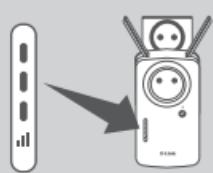
Ako pametne signalne LED lampice prikazuju jednu narančastu traku nakon završetka postupka povezivanja, uređaj DAP-1635 je uspostavio vezu slabe kvalitete. Za poboljšavanje kvalitete veze, uređaj DAP-1635 treba premjestiti tako da bude uključen u električnu utičnicu bližu izvornom bežičnom usmjerniku ili pristupnoj točki. Što više osvijetljenih traka signalne LED lampice prikazuju, to je bežični signal bolji.
