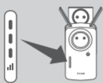
Pokud se po dokončení nastavení připojení objeví na kontrolce Smart Signal oranžový pruh, zařízení DAP-1635 nastavilo slabé připojení. Chcete-li zlepšit kvalitu připojení, měli byste zařízení DAP-1635 přemístit k zásuvce blíže zdrojovému bezdrátovému směrovači nebo přístupovému bodu. Čím více rozsvícených panelů na kontrolce LED, tím kvalitnější bezdrátový signál.
