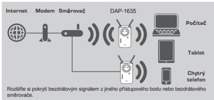
Rozšiřte si pokrytí bezdrátovým signálem z jiného přístupového bodu nebo bezdrátového směrovače.
