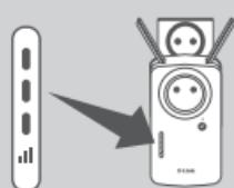
Om Smarta signallysdioder har en gul stapel efter att anslutningen är klar har DAP-1635 etablerat en dålig anslutning. För att förbättra anslutningens kvalitet bör DAP-1635 flyttas till ett vägguttag närmare den trådlösa källrouter eller AP:en. Ju fler staplar som är tända på signallysdioderna, desto bättre trådlös signal.
