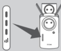
Jeśli po nawiązaniu połączenia dioda intelligentny wskaźnik LED świeci się na pomarańczowo, oznacza to, że jakość połączenia urządzenia DAP-1635 z siecią jest niska. Aby poprawić jakość połączenia, urządzenie DAP-1635 należy umieścić w gnieździe elektrycznym znajdującym się w pobliżu routera Wi-Fi lub punktu dostępu. Im więcej pasków świeci się na wskaźniku LED, tym mocniejszy jest sygnał sieci bezprzewodowej.
