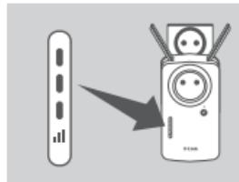
Se o Sinal LED Inteligente apresentar uma única barra âmbar após terminar o processo de ligação, significa que o DAP-1635 estabeleceu uma ligação de fraca qualidade. Para melhorar a qualidade da ligação, o DAP-1635 deve ser deslocado para uma tomada de corrente mais próxima do router ou do PA sem fios de origem. Quanto mais barras estiverem acesas no Sinal LED, melhor será o sinal sem fios.
