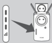
Toont de Smart Signal LED na het voltooien van het verbindingssproces een enkele gele balk, dan heeft de DAP-1635 een verbinding van slechte kwaliteit. Om de verbindingskwaliteit te verbeteren, verplaatst u de DAP-1635 naar een stopcontact dat zich dichter bij de draadloze router of AP bevindt. Hoe meer balken op de signaalled branden, hoe beter het draadloze signaal.
