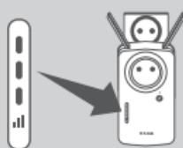
Se il LED del segnale smart mostra una singola barra arancione al termine del processo di connessione, DAP-1635 ha stabilito un collegamento di scarsa qualità. Per migliorare la qualità della connessione, spostare DAP-1635 su una presa a parete più vicina al router wireless o al punto di accesso di origine. Maggiore è il numero di barre illuminate sul LED del segnale e migliore sarà il segnale wireless.
