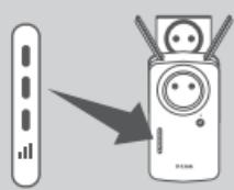
Si el LED de señal inteligente tiene una sola barra en ámbar una vez finalizado el proceso de conexión, el DAP-1635 ha establecido una conexión de poca calidad. Para mejorar la calidad de la conexión, se debe cambiar la ubicación del DAP-1635 a una toma de pared más cercana al router inalámbrico o AP de origen. Cuantas más barras iluminadas haya en el LED de señal, mejor será la señal inalámbrica.
