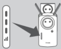
Hvis Smart LED-signalen lyser gult med én enkelt lampe etter at tilkoblingsprosessen er fullført, har DAP-1635 etablert en tilkobling med dårlig kvalitet. For å forbedre tilkoblingens kvalitet bør DAP-1635 flyttes til en stikkontakt nærmere den trådløse kilderuteren eller kildetilgangspunktet. Jo flere LED-lamper som lyser, desto bedre er det trådløse signalet.
