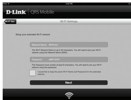
È possibile mantenere il nome di rete (SSID) e la password correnti per la rete Wi-Fi estesa oppure immettere un nuovo nome di rete e una nuova password. È quindi possibile scegliere di creare una password dell'amministratore per accedere all'utilità di configurazione basata sul Web del dispositivo DAP-1320. Toccare Avanti per continuare.
