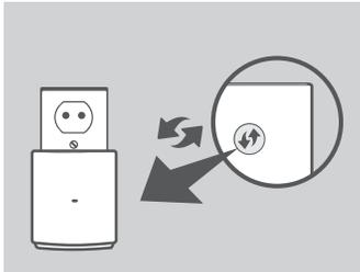
Collegare il dispositivo DAP-1320 a una presa a muro e attendere finché il LED Power sia acceso e di colore giallo. Premere il pulsante WPS del router wireless sorgente o AP, quindi premere il pulsante WPS del dap-1320. Il LED inizia a lampeggiare in verde.
