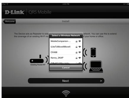
Aprire QRS Mobile. Verrà visualizzata la Configurazione guidata. Fare clic su Avvia per iniziare. Il dispositivo DAP-1320 inizierà a cercare le reti wireless dai router o dai punti di accesso wireless circostanti. Selezionare la rete wireless di cui estendere la portata e immettere la password, se necessario.
