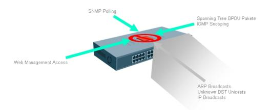
Erst durch Einschalten der D-Link SafeGuard Engine wird die Switch CPU in die Lage versetzt, die Flutpakete zu drosseln und den notwendigen Teil der zur Verfügung stehenden CPU Bandbreite für die Überwachungs und Steuerungsfunktionen zu reservieren.
