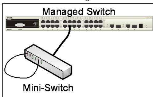
Häufig werden kleine 5- oder 8-Port Switche verwendet, um z.B. in Büros fehlende Netzwerkanschlüsse bereit zu stellen. Eine Neuinstallation und Neuverkabelung von Netzwerkdosen in Bodentanks oder Wandleisten ist sehr teuer – da dienen Mini-Switche als kostengünstige Alternative. Sind diese Switche nicht konfigurierbar (= unmanaged), so hat ein Netzwerkadministrator keine Möglichkeit, angeschlossene Geräte zu überwachen und Fehler zu entdecken. Gerne werden in solchen
