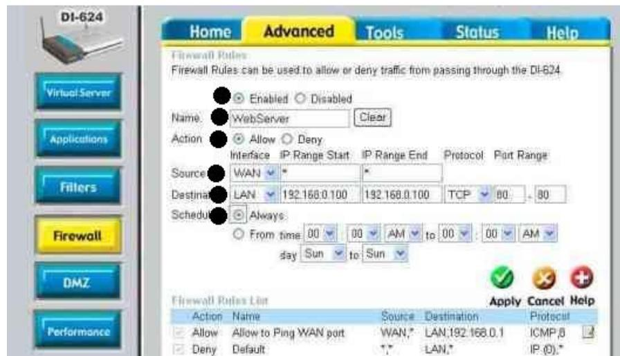
**Abbildung** oben: Firewall-Konfiguration am Beispiel eines Web-Servers.
