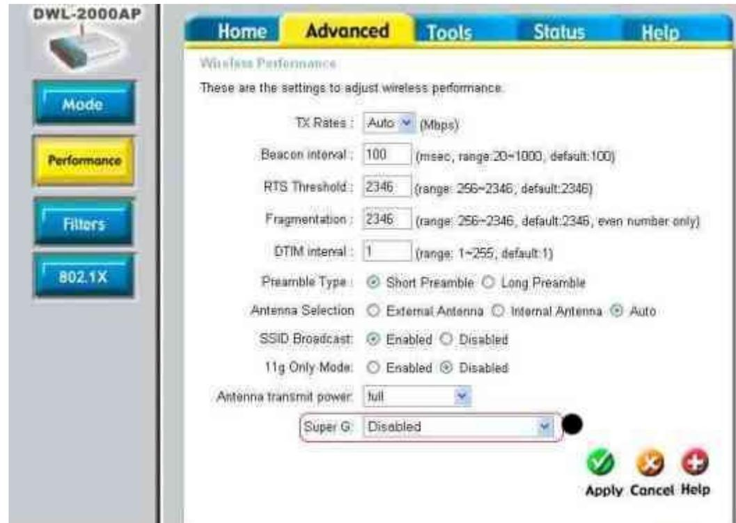
**Abb. oben:** Auch ein eventueller SuperG Mode muss abgeschaltet (disabled) sein; Der 11g Only Mode lässt nur 54MBit-Geräte (802.11g-Standard) zu, wenn er auf enabled steht
