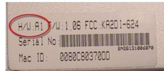
**Abbildung oben:** Unten ist die aufgespielte Firmware-Version beim Firmware-Update (z.B. F/W: 1.01) aufgedruckt. Ihre Firmware-Version vergleichen Sie mit den neuesten Versionen im Internet.
