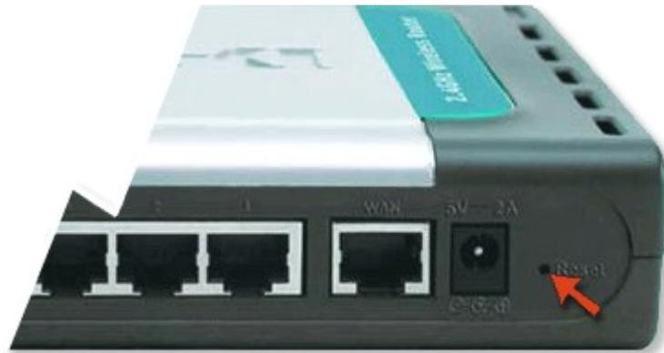
Der Reset der Geräte wird wie folgt durchgeführt: Bitte drücken Sie für **ca. 10 Sekunden** den im Bild markierten ins Gerät eingelassenen Resetknopf mit einer Kugelschreibermiene bzw. Büroklammer.
