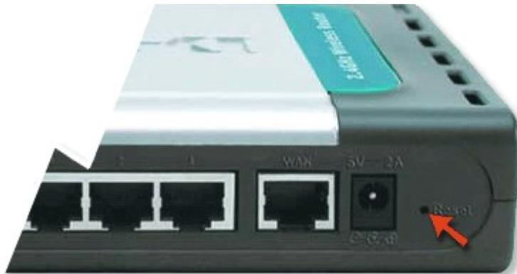
Der Reset der Geräte wird wie folgt durchgeführt: Bitte drücken Sie für **ca. 10 Sekunden** den im Bild markierten ins Gerät eingelassenen Resetknopf mit einer Kugelschreibermine bzw. Büroklammer.
