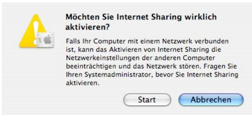
Aktiviertes und falsch konfiguriertes „Internet Sharing“ kann zu Problemen mit der WLAN-Funktion führen! Möglicherweise erreichen Sie unsere Geräte nicht mehr.
